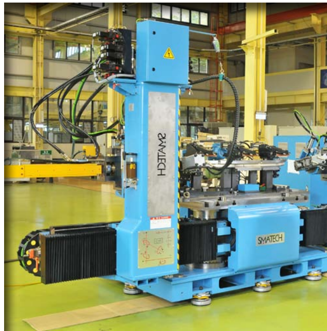
雙臂伺服彎曲機具備智慧調控功能，提高彎取的精準度。
