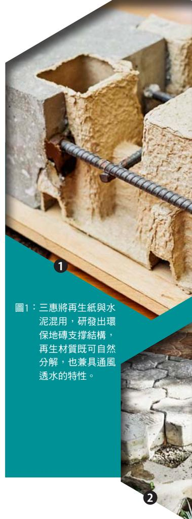
圖1：三惠將再生紙與水泥混用，研發出環保地磚支撐結構，再生材質既可自然分解，也兼具通風透水的特性。
