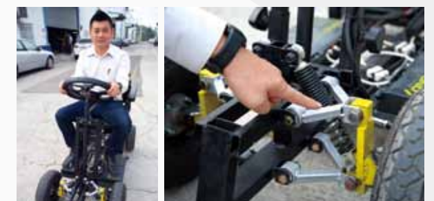
群聚調整電動代步車底盤設計，將電池前移轉向調整及重心平衡，提高騎乘時的穩固。
