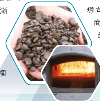
正大投入近三千萬元更改鍋爐設備，改以棕櫚殼做為烘乾紙漿的燃料，燃燒後無毒物又省下空汙費。
