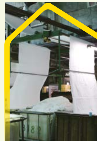
尚益將連續退漿製程運用廢熱水循環加熱，省電又省燃料。
