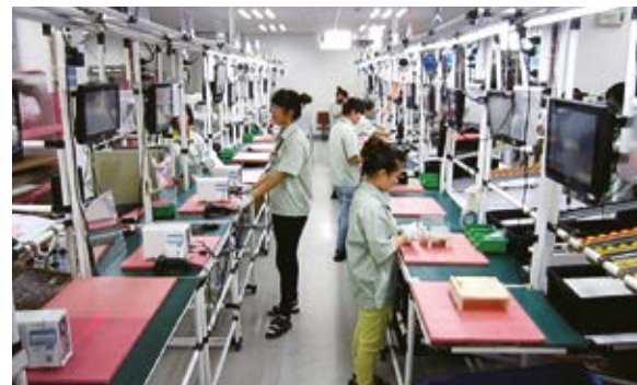
輔導團隊將威強電原本傳統直線型的生產線改為U型的多線體生產線，人力配置更精準、少量多樣生產更快速。
