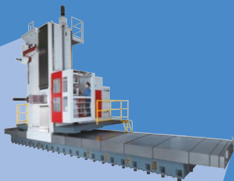
達佛羅成功將基礎科學與機電整合技術結合，量產大型的滑枕型臥式搪銑床，對國內能源、船舶、油氣設備產業競爭力的提升相當有助益。
