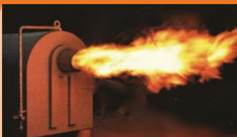
木顆粒燃燒機是群聚重要成果，可直接外掛式加裝，不需大幅更換掉原本使用的化石燃料設備。
